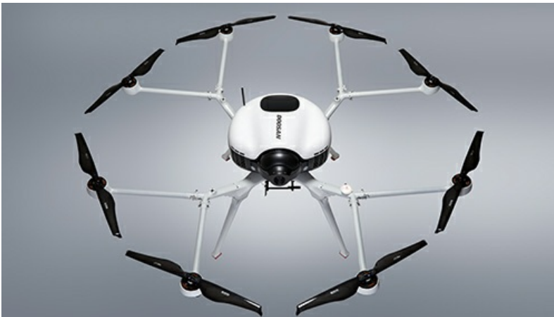
Droonid ja UAV-d - vesiniku kütuseelemendiga kauakestev Doosan Mobility Innovationi droon, mis võib laadimata õhus püsida tunde.
