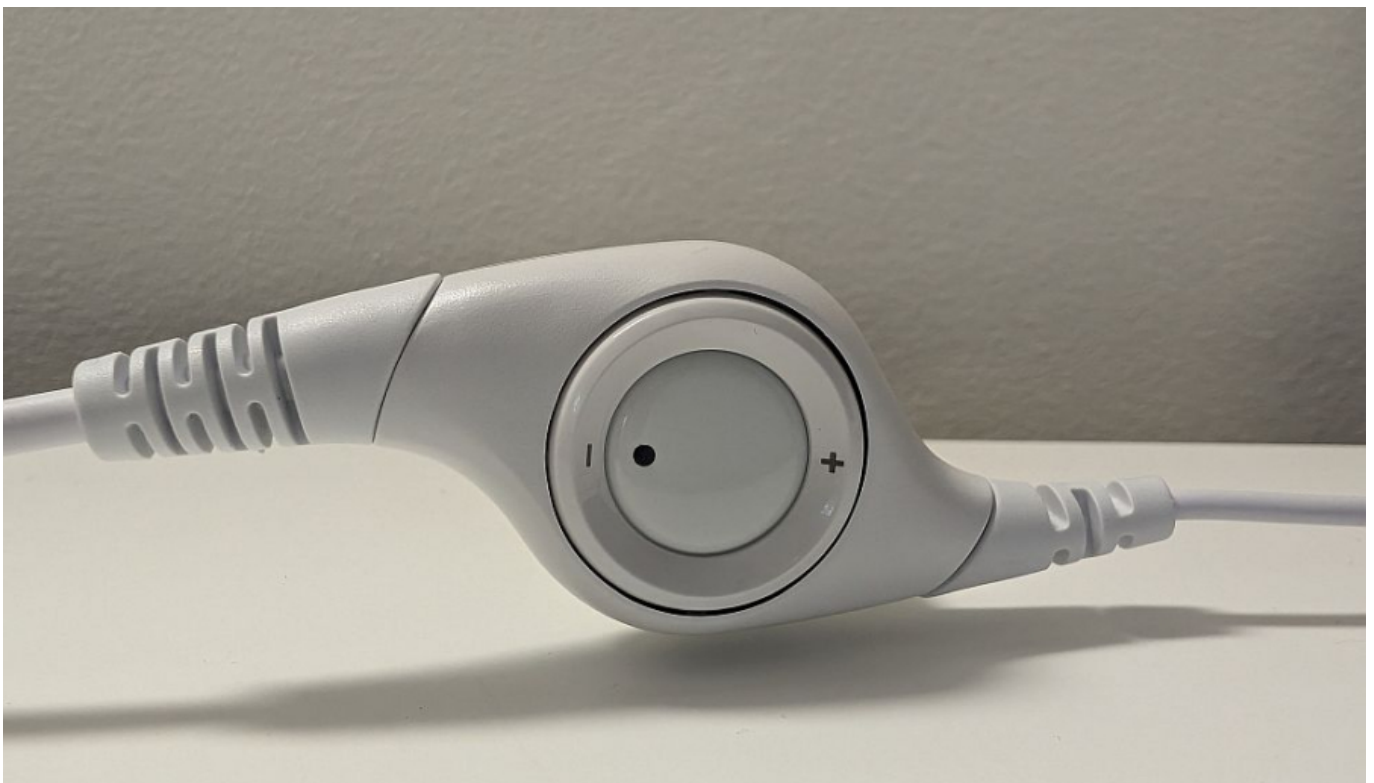
Juhtpuldist, mis asub juhtmel, saab reguleerida helivaljust (rõngas) ja mikrofoni sisse-välja lülitamist (keskmine nupp)
