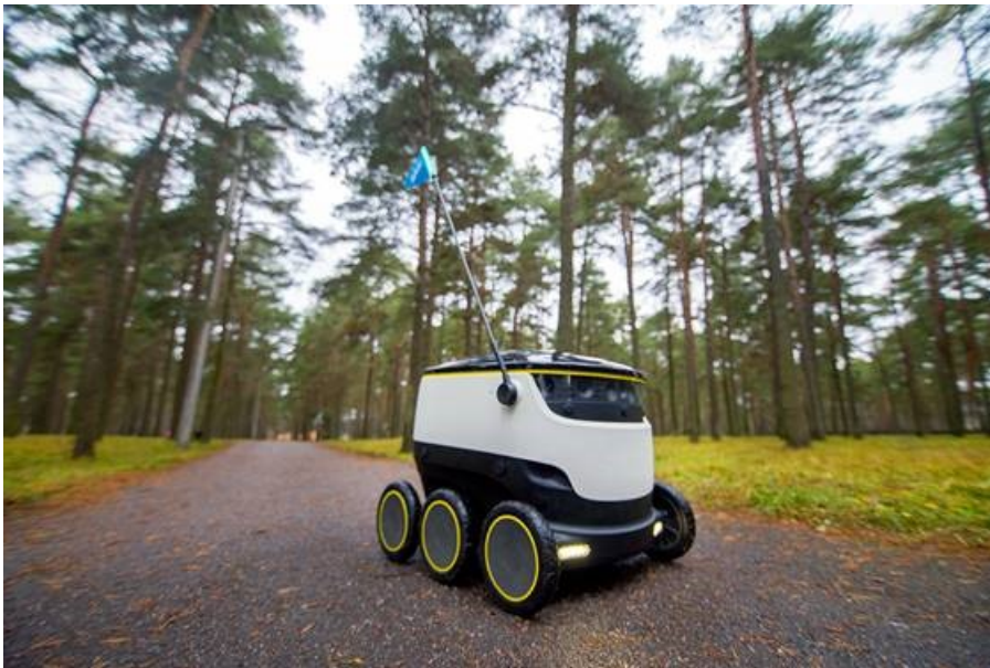
Starship suundumas kliendi poole (TTÜ taga metsas?). Robot on disainitud sõitmaks erinevatel pinnastel, sealhulgas teeületuskohtadel ning kõnniteedel ja üle äärekivide.
